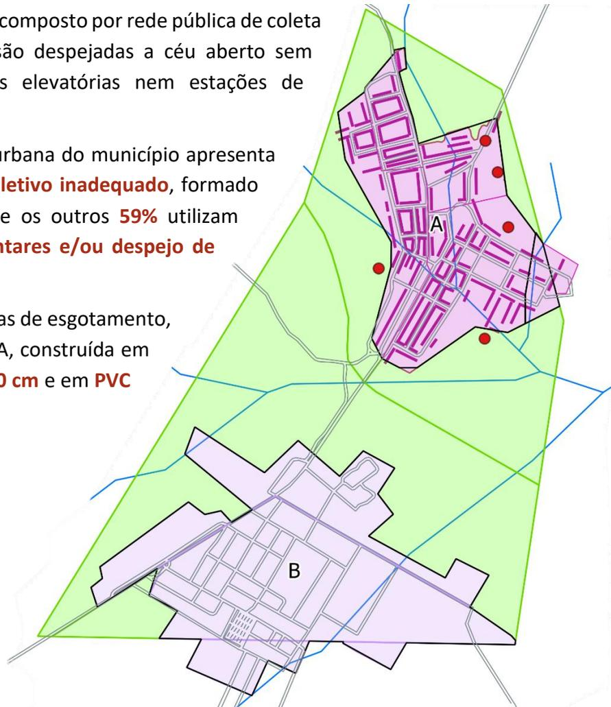
O sistema de esgotamento conduz as águas cinzas por meio de coletores, com extensão total de **6,1 km**, que encaminham os efluentes até **pontos difusos de lançamento de esgoto a céu aberto**, sem tratamento. O esgoto lançado escoar até corpos receptores e para um açude localizado no limite urbano do distrito.
